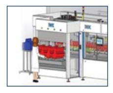
Три накопителя для сложенных выкроек пенала, которые оператор загружает вертикально в накопители. Сложенные выкройки пеналов захватываются и перемещаются на станцию формовки, где происходят их формовка и размещение на транспортные спутники.
