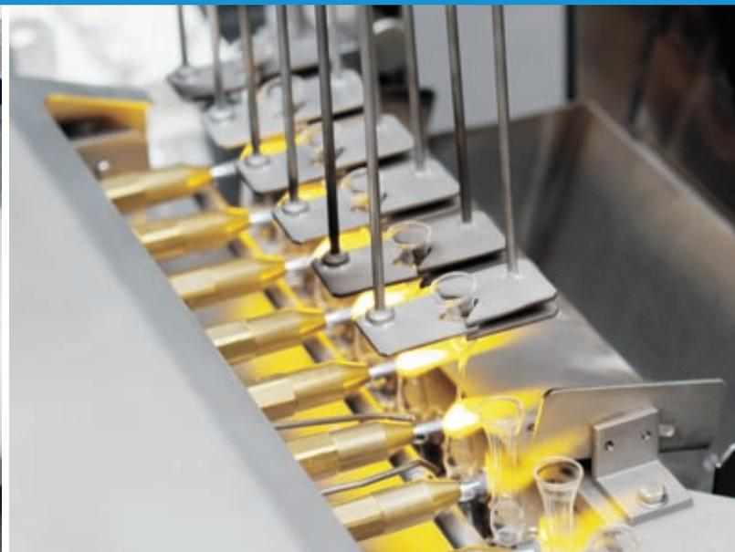
Станция предварительного нагрева и запайки
