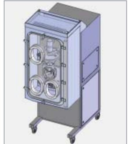
Компактная установка на мобильной раме включает уплотнительный шнек, загрузочную воронку объемом около 5 л, валковый компактор и ситовую мельницу.
