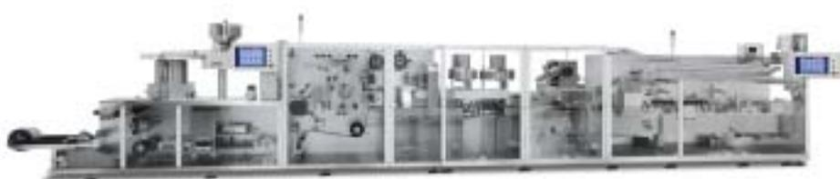
**А**втоматическая блистерная машина HM 600R развивает скорость до 600 блистеров в минуту. Объединив новейшие разработки и огромный опыт, инженерам компании Hoong-A удалось создать машину, которая в настоящий момент является флагманом в своем классе. Блистерная машина HM 600R может
