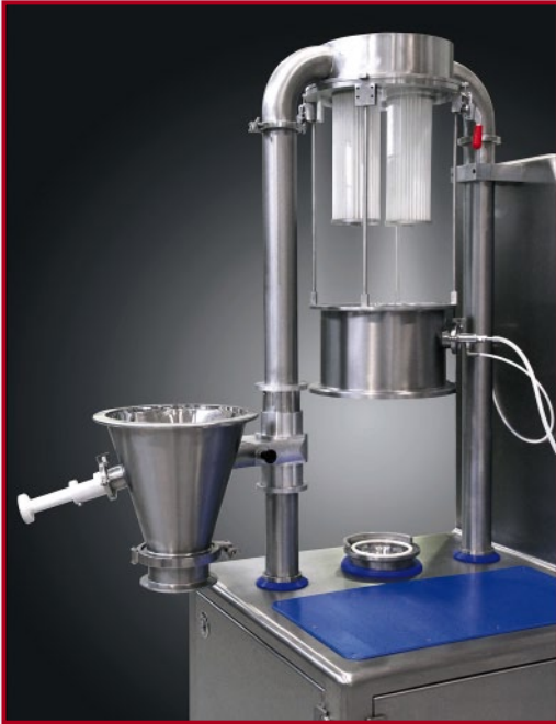
Contenitore mobile e ribaltabile per scarico prodotto Mobile, tiltable container for product discharge
