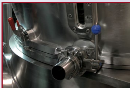
Scarico con trasporto pneumatico Discharge through pneumatic transport
