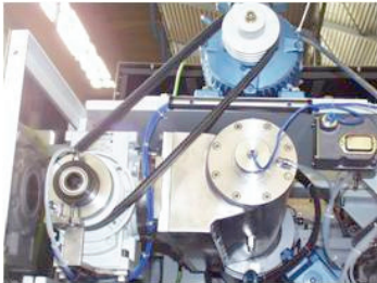
Электромеханическая система инверсии фильтрующей ткани
