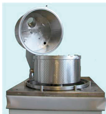
Исполнение ALFA/S-GMP с возможностью полной инспекции по требованиям GMP
