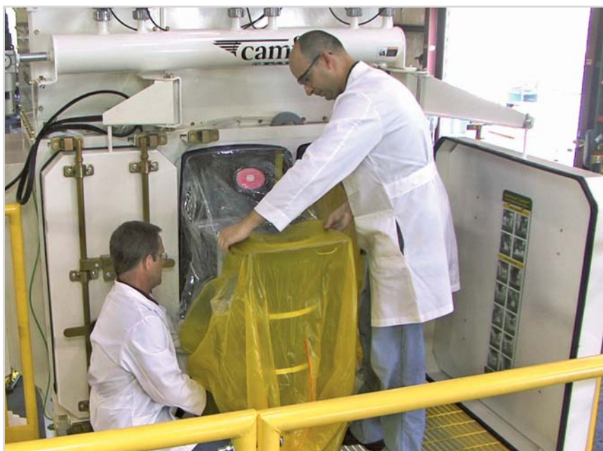
Тестирование безопасной замены фильтров (BIBO – Bag In Bag Out)
