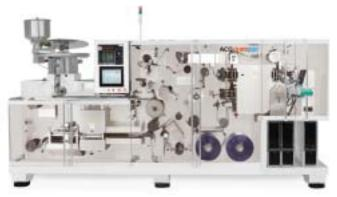
зайн балконного типа, облегчающий доступ для мытья и эксплуатации; дополнительная охлаждающая плита после стадии линейной индексации для лучшего охлаждения сформованной ячейки; система вырубки Edge to Edge, позволяющая достичь безотходного производства в направлении движения блистеров; сервоприводная система PRC периодического типа; увеличенная площадь нагрева, позволяющая повысить эффективность формования; полная 3D-замена сменной оснастки, сервоприводная индексация высокой точности.
